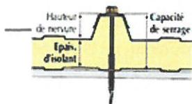
Ep. isolant + hauteur nervure à comparer avec capacité de serrage
